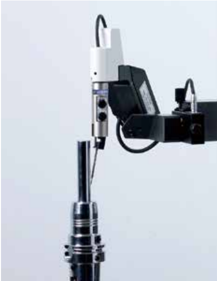
오프셋형 CNC 검출기 홀더 (옵션) 을 이용한 진원도 측정 예
