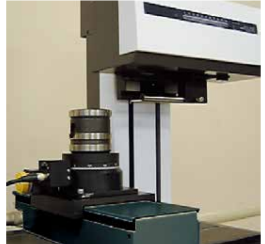
Y軸CNCテーブル(100 mm)と θ軸CNCテーブル(水平)の組み合わせ例
